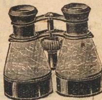
**274. Jumelle de nuit**, "Grand Angle", monture conique émaillée noir avec écrans fixes, garnie peau de porc, branches articulées pour l'adaptation exacte des oculaires à l'écartement des yeux, étui peau rigide avec courroie et passant pour le ceinturon, 6 verres achromatiques extra, grossissement 4 fois, champ 220 mètres, diamètre des objectifs 48 m/m, longueur fermée 9 c/m, poids 700 grs. 60. »
