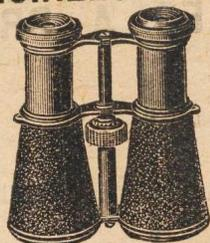
**272. Jumelle à triple usage**, dite "Polydioptrique" monture bronze et aluminium, émaillée noir, garnie maroquin. Dispositif pour régler les oculaires à l'écartement des yeux. Livrée en étui cuir rigide, avec courroie, 10 verres achromatiques, objectifs de 50 m/m, h<sup>r</sup> 10 c/m, p<sup>ds</sup> 350 grs. Une disposition des oculaires munis de 2 disques mobiles, permet d'obtenir 3 grossissements : 3, 5 et 7 fois (théâtre, marine, campagne), et 3 champs distincts : 70, 50 et 30 m. 56. »
